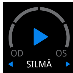
Tonometri on valmis suorittamaan mittauksia. Valitse silmä: OD (oikea silmä), silmää ei valittu, OS (vasen silmä).
